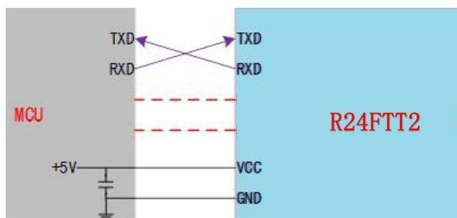
图 4 雷达模块与外设连线示意图
