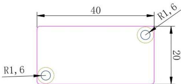
图 3 雷达模块封装尺寸图(mm)
