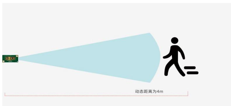
图 6 水平安装示意图
