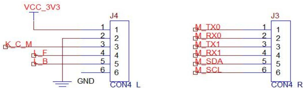
如板子丝印一致，M\_TX0、M\_RX0 为 MCU 串口 1，M\_TX1、M\_RX1 为 MCU 串口 2，M\_SDA、M\_SCL 为光感驱动接口（IIC）
