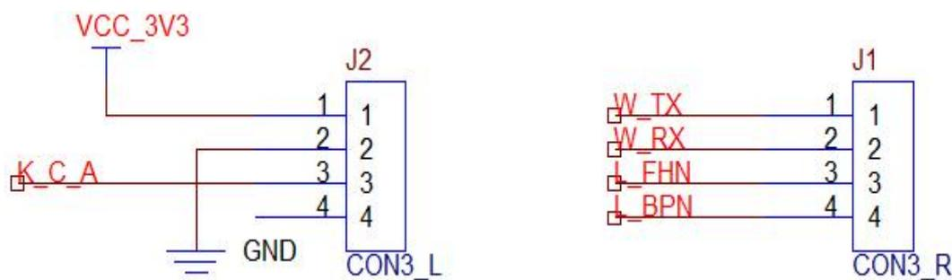
如板子丝印一致，W\_TX、W\_RX 为连接模组串口，L\_FHN、L\_BPN 分别为连接模组 IO。
